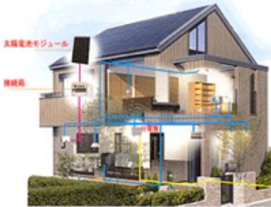
太陽光発電システム
